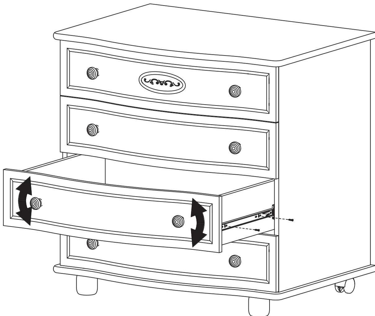
Если после установки ящиков зазоры между ними распределяются неравномерно - выдвиньте ящики, выкрутите 2 первых самореза (от лицевой стороны) и отрегулируйте зазор.
