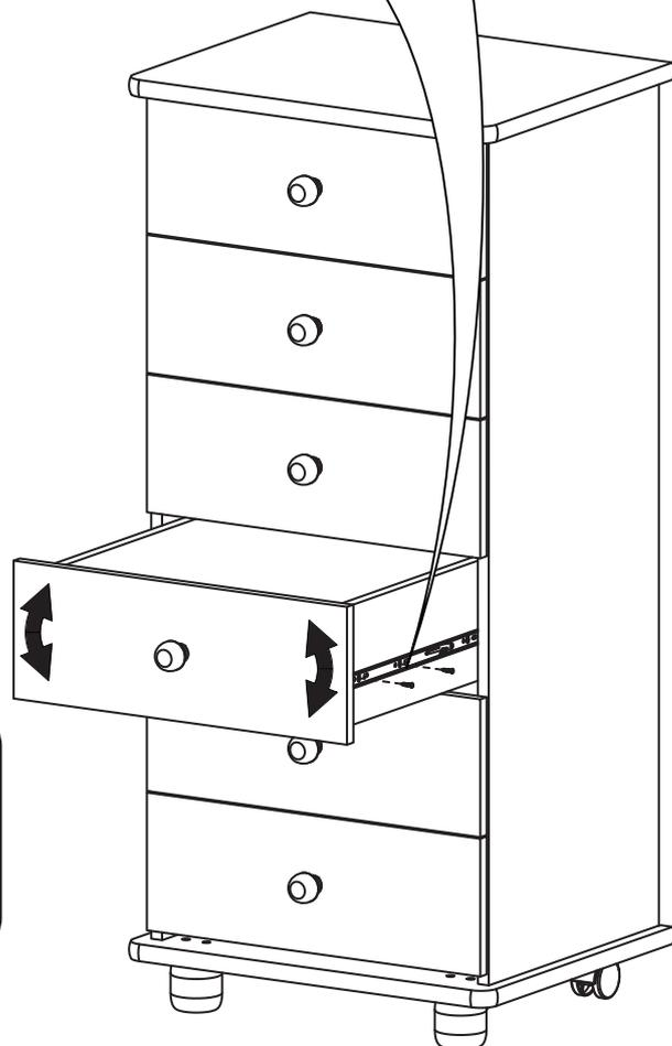
Если после установки ящиков зазоры между ними распределяются неравномерно - выдвиньте ящики, выкрутите 2 первых самореза (от лицевой стороны) из круглых отверстий и закрутите их в продолговатые пазы. Это позволит отрегулировать зазор между ящиками.
